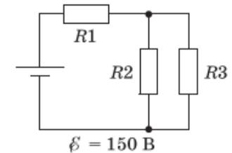
5. Найдите полную мощность, выделяемую в электрической цепи (рис. 3).
